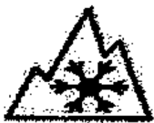
Рисунок 5.1. Маркировка, наносимая на зимнюю шину
